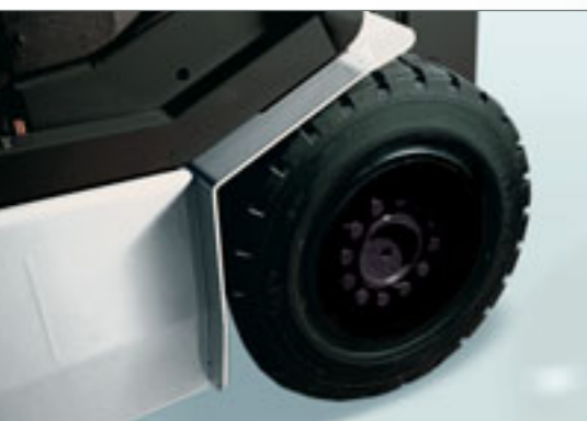
Neumáticos super-elásticos (la fotografía muestra un modelo de 3 tons)
